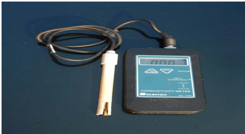
圖一 電導度計 (EC meter)，右圖為電導度計之電級區及左圖為白金桿和溫度感應桿
