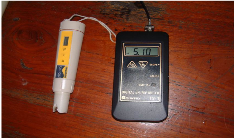
圖二 常用之酸鹼度計，單點校正式(左)及雙點校正式(右)
